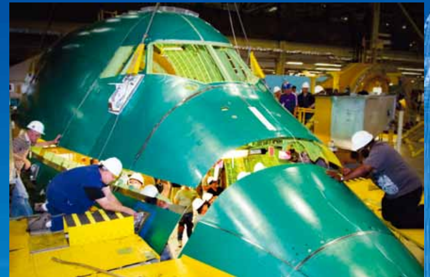
华盛顿州埃弗雷特工厂的机械师将第41段安装到首架747-8洲际客机上。这一机身段容纳上舱中的驾驶舱及主舱中的前客舱。
