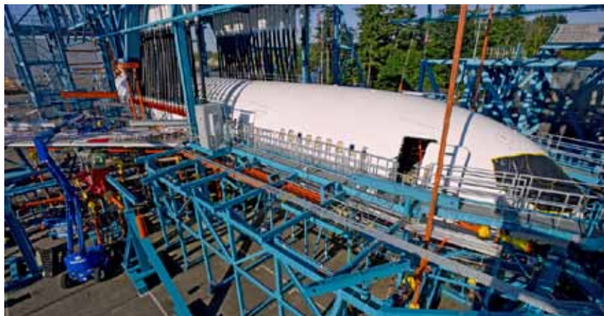
波音开始对787梦想飞机的机体结构进行疲劳试验
