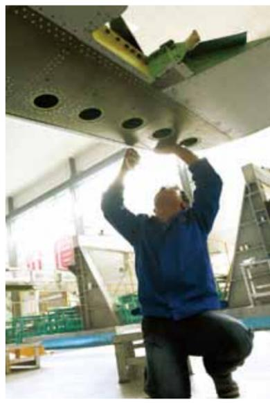
上海飞机制造公司的员工正精心装配新一代波音737水平尾翼
