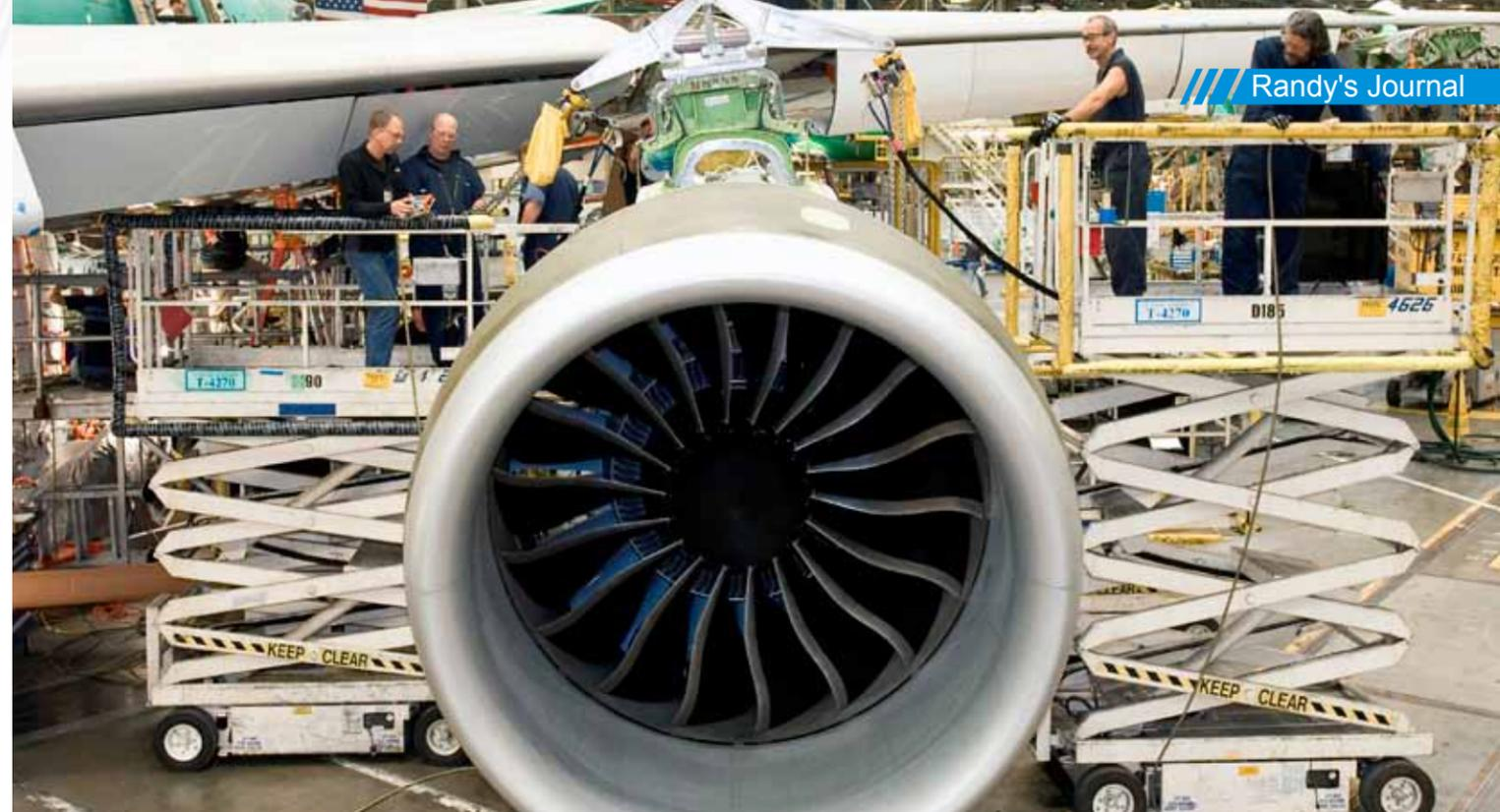
747机械师正在为首架747-8飞机安装左机翼内侧的GEnx-2B发动机。
