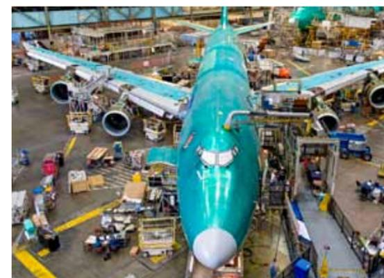
埃弗雷特工厂1号747-8飞机的翼下发动机
