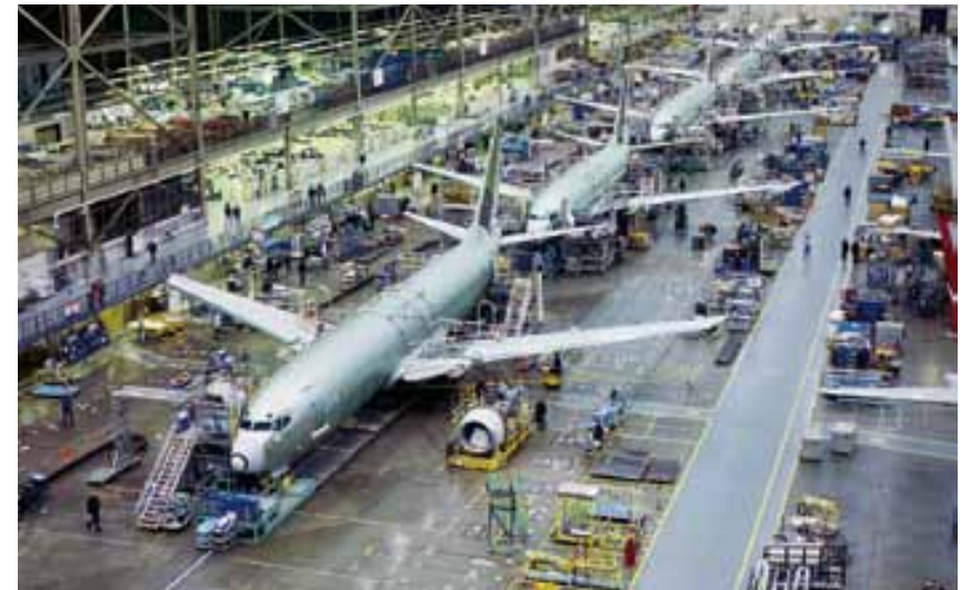
波音737快速移动生产线是航空业精益生产方式的典范
